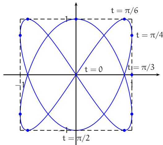
Les courbes de LISSAJOUS sont les courbes de paramétrisation  $\begin{cases} x = a \sin(pt) \\ y = b \sin(qt + \varphi) \end{cases}$ . Si on les visualise sur l'écran d'un oscilloscope, elles permettent suivant le cas de visualiser le déphasage ou le rapport de fréquence entre deux signaux sinusoïdaux, l'un rentré en abscisse et l'autre en ordonnée.
